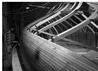
SLIKA 15. Gradnja broda Mardešićevom tehnikom s pomoću uskih drvenih letava, Brodogradilište Split, 2010. / FIGURE 15. Building a ship with Mardešić's technique using staves, Shipyard Brodogradilište Split, 2010
