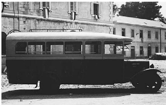
SLIKA 12. Mardešićovo brodogradilište, 1931.; autobus s karoserijom izrađenom od drvenih letava / FIGURE 12. Mardešić's shipyard, 1931; bus with bodywork made from staves
