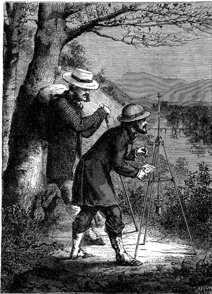
Sl. 43. Fortinov barometar namješten za opažanje na polju.
